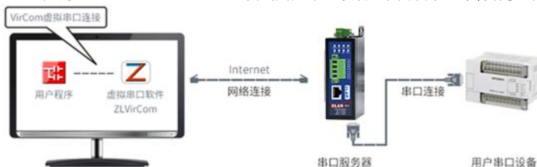
图 22 虚拟串口的作用
